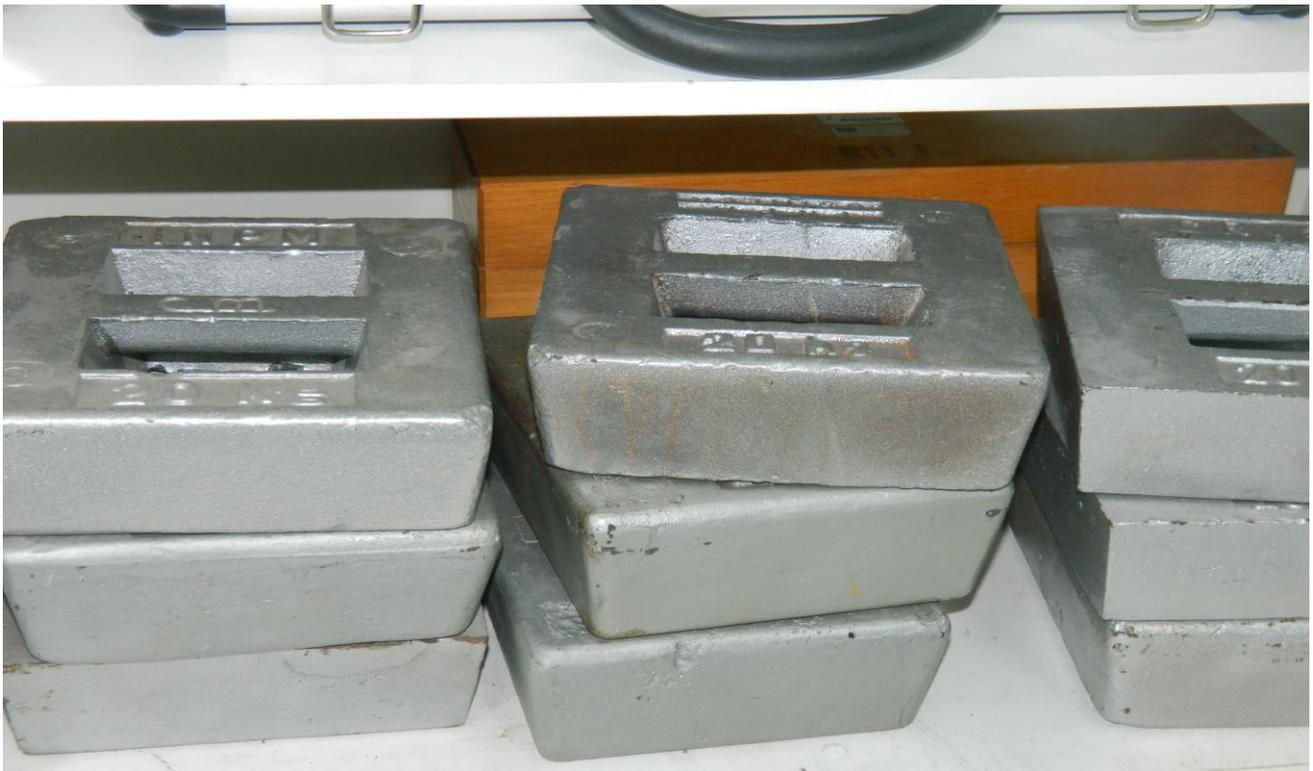
**Foto 04** – para aferição de balanças, é necessário utilização de vários pesos no laboratório metrológico de massas, todos feitos um a um até conclusão do peso ideal, conforme especificações do INMETRO.
