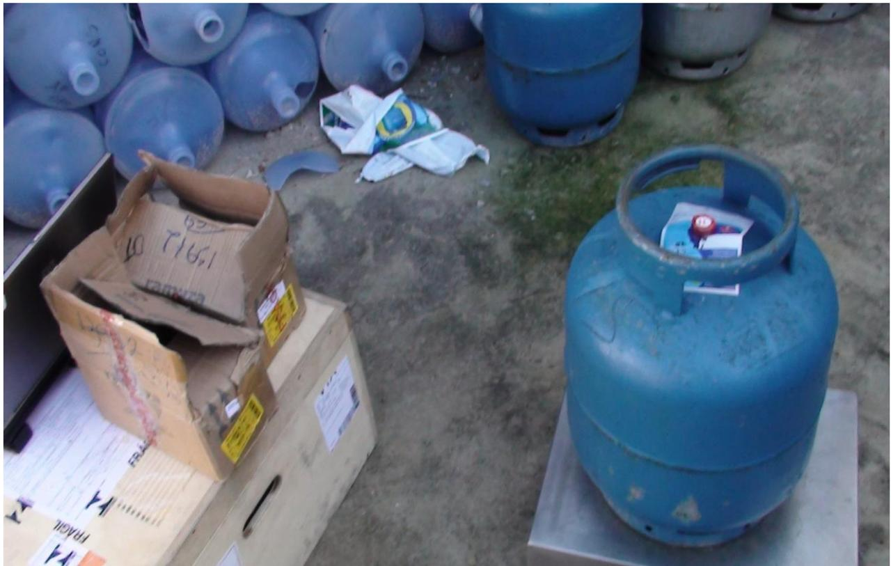
**Foto 08** – aferição das botijas de GLP nos depósitos.
